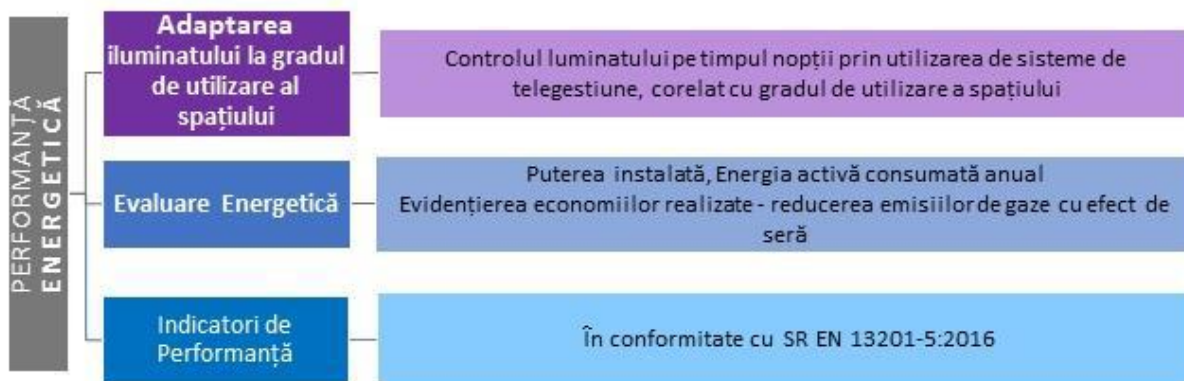
Figura 8 – Niveluri de performanță pentru sistemul de iluminat – performanță energetică
